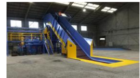
株式会社昭和製省エネ油圧ジャンボプレス機 電気料金約25%削減(高松工場)
